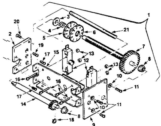
FIGURE 8-8. MOTOR BRAKE PARTS
